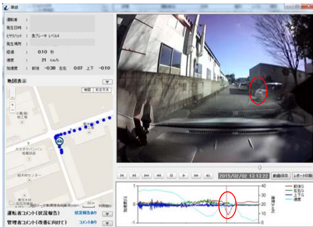
図-13 抽出されたヒヤリ・ハットの状況
