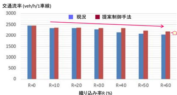
図 提案手法による交通処理能力（1+1車線）
