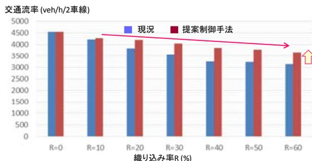
図 提案手法による交通処理能力（2+2車線）
