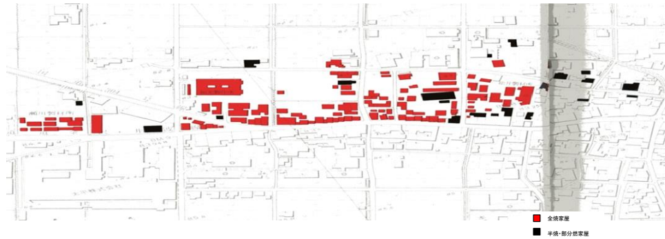
図-10 実火災の延焼面（出火 86 分後）
