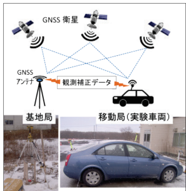
図-3 GNSS衛星測位システムの概要
