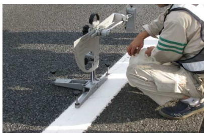
写真-6 すべり抵抗測定状況
