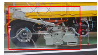
機械の取付が現場作業 (回送時に取り外す必要有)
