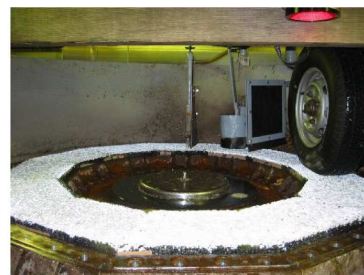
写真-1 耐摩耗性（回転タイヤ式ラベリング）試験
