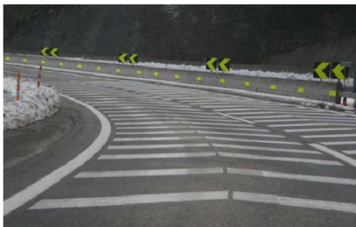
写真-11 AWTを用いたシェブロン路面標示昼間視認状況
