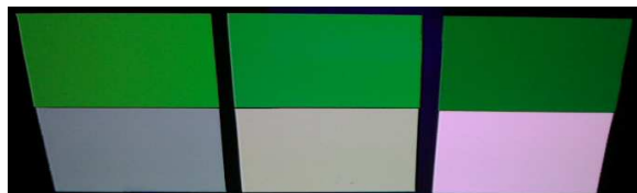
写真-3 標識発光シートの発光状況(緑/白)
