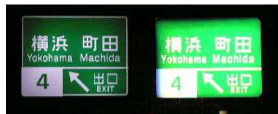
写真-2 発光方式と反射方式の比較
