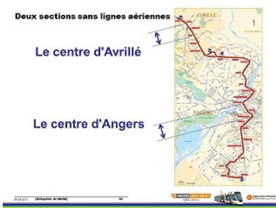
図-2 APS方式の採用区間<sup>9)</sup>
