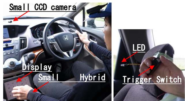
図-4 運転挙動の計測装置
