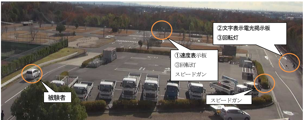
図 2-1 デバイスの設置状況
