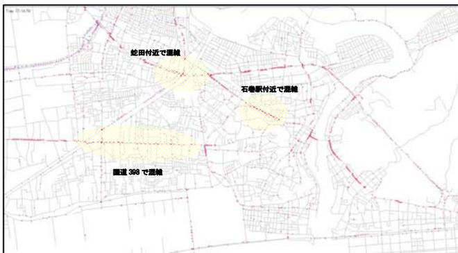
図-11 シミュレーション演算による平常時渋滞発生状況(2012年12月6日 17:15時点)
