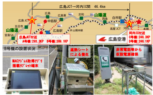
図-4 計測対象区間とタブレット端末の設置状況
