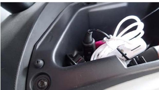
図-24 ダッシュボード内に格納した端末とバッテリー
