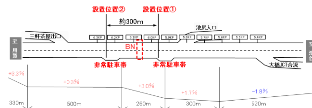
図-4 LED表示板設置位置
