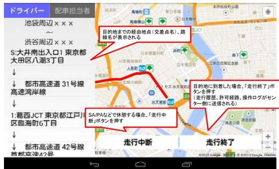
図-3 ドライバーの操作画面のイメージ
