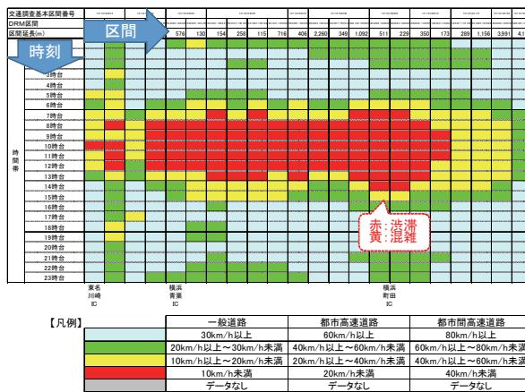
図-2 時空間速度図の出力例（東名高速道路）
