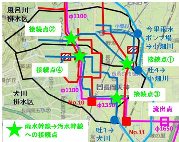
図-7 雨水幹線と汚水幹線の接続点
