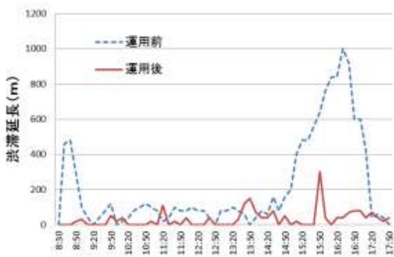
図-3 集中管理ゲートの導入前後での TCB ゲート前の渋滞長さの変化
