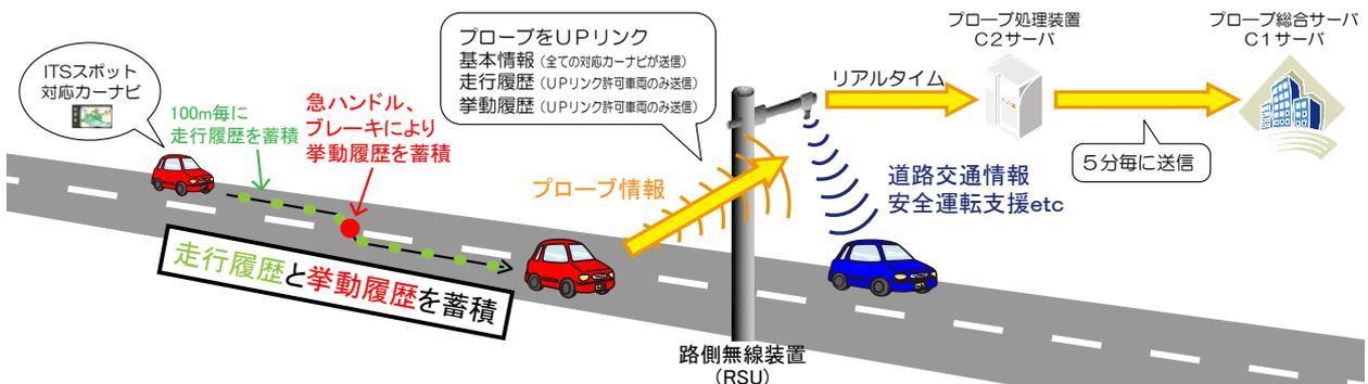
図-3 ITSスポットの双方向通信とデータの流れ
