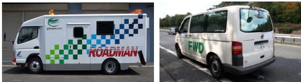
(a) 路面性状測定車 (b) FWD測定車
