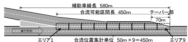
図-5 宮野木 JCT 合流部模式図
