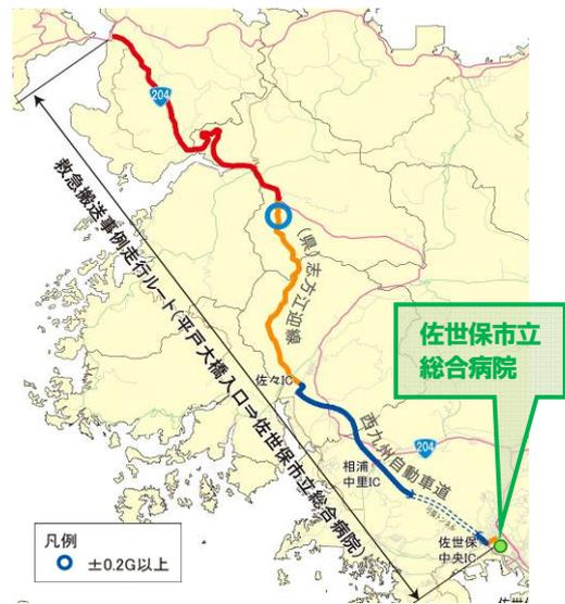
図-9 救急搬送事例走行ルート及び前後加速度  $\pm 0.2G$  以上計測箇所（救急車両）
