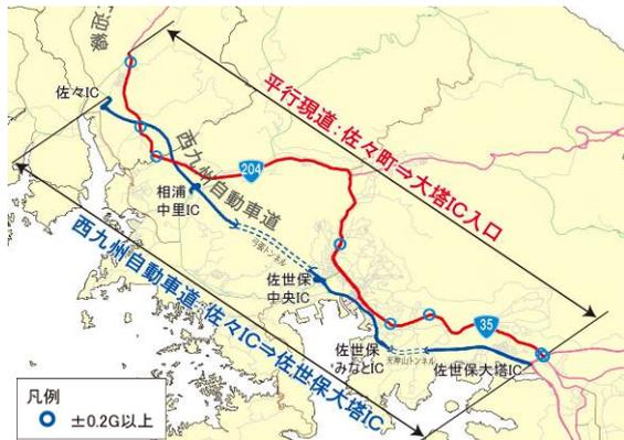
図-4 加速度調査区間及び前後加速度±0.2G以上計測箇所 (福祉タクシー)
