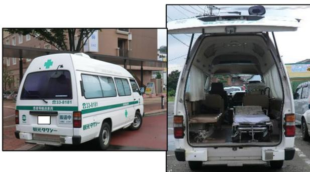
図-2 福祉タクシーを用いたプローブ・加速度調査車両
