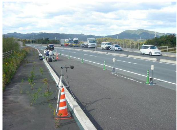
写真-3 騒音計測時の交通量調査実施事例
