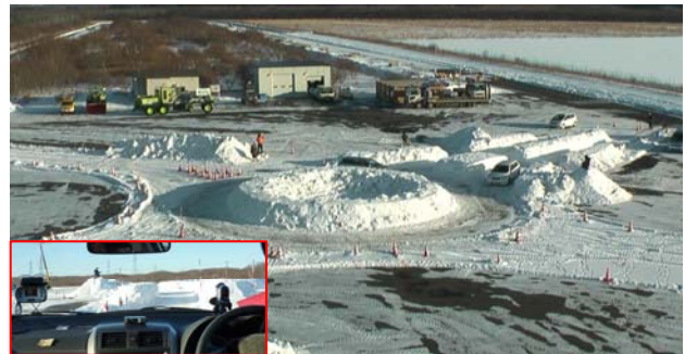
写真-3 冬期走行試験の状況（堆雪高さ1.2m）
