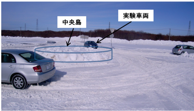
写真5 ラウンドアバウトの走行実験状況（冬期）
