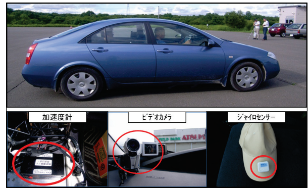
写真-3 実験車両 (日産プリメーラ) と各計測器
