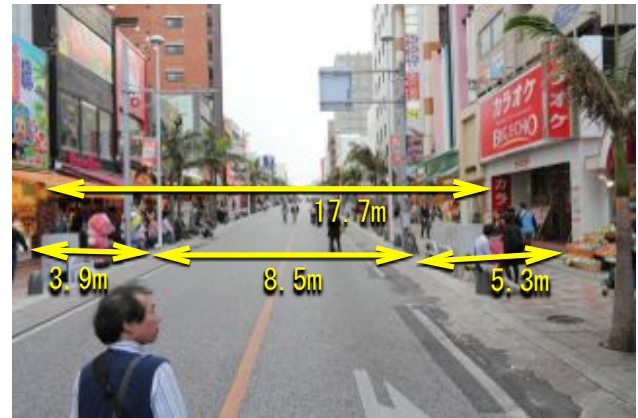
写真-8 那覇 (国際通り) の幅員構成
