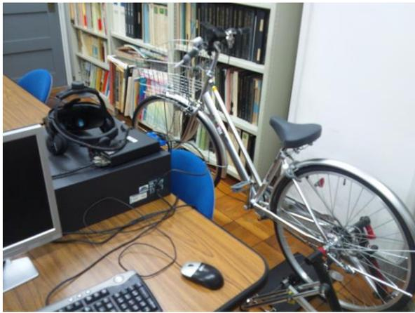
図-2 自転車シミュレータ
