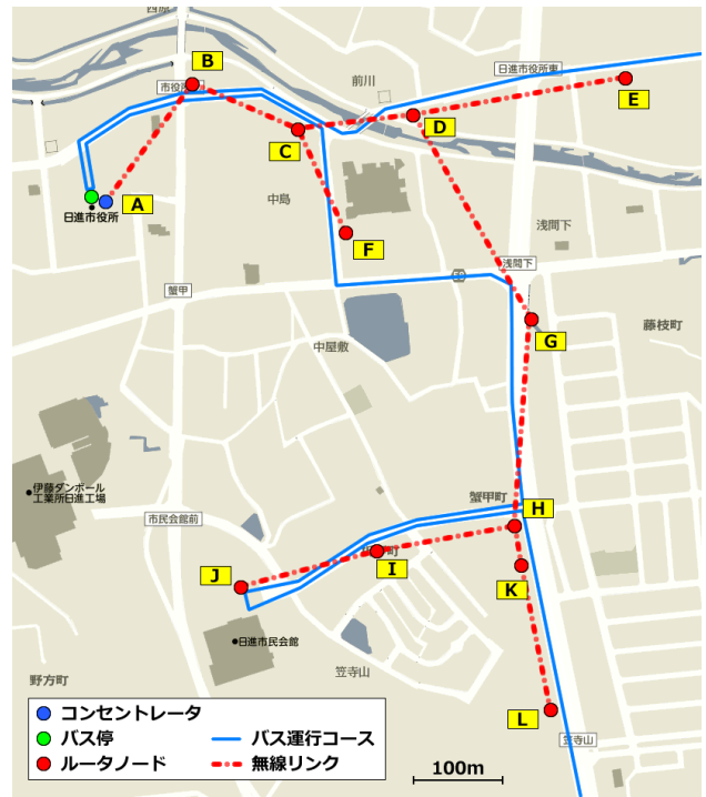
図-6 センサボックスの設置位置とネットワークポロジ
