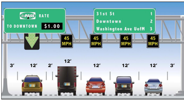
図一五 米国ミネソタにおけるダイナミック・プ ラシングの表示事例 17) (左端のレーンにおいて、混 雑の程度に応じて料金が動的に変動)
