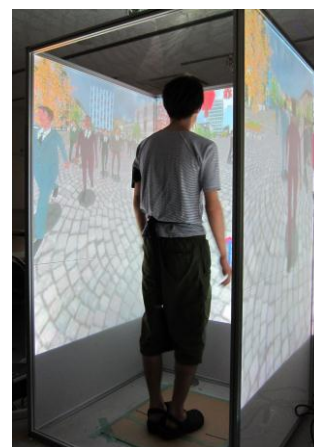
図-2 半没入型VR装置
