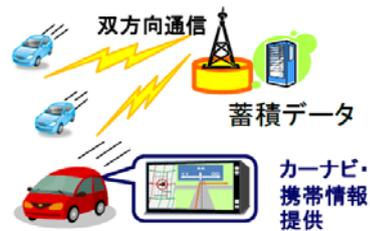
図-3 一般車両のプロブデータの取得
