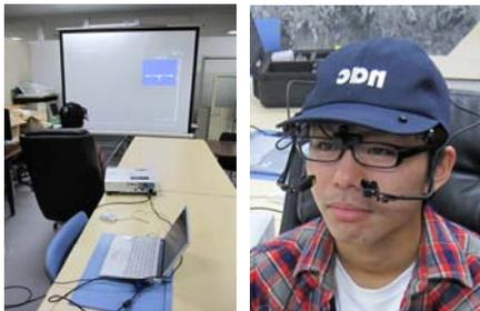
図-1 アイマークレコーダを用いたシミュレータ実験の様子
