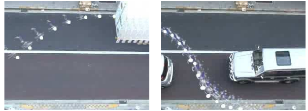
図-12 障害物がある場合の斜め横断軌跡の例
