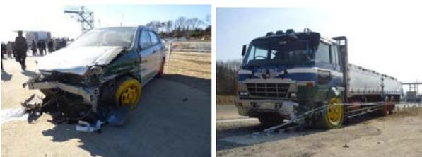
写真-25 衝突後の車両破損状況
