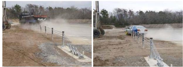
写真-12 衝突時の状況 (左: 大型車, 右: 乗用車)
