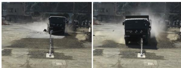
写真-19 大型車の防護柵衝突後の軌跡
