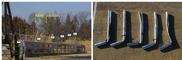
写真-17 衝突後の防護柵の破損状況
