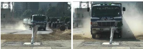
写真-24 防護柵衝突後の大型車の軌跡
