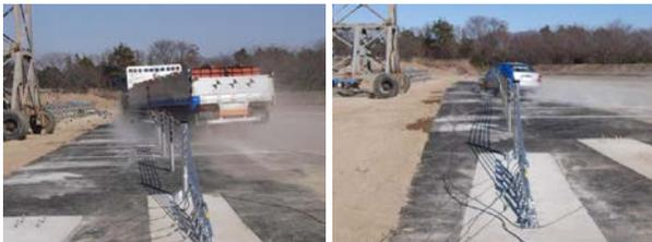
写真-23 車両衝突時の状況
