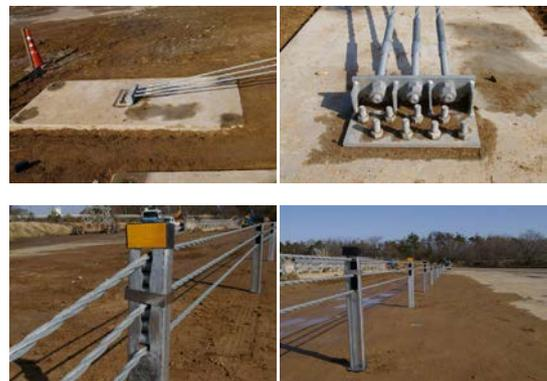
写真-7 ワイヤーロープ式防護柵の供試体設置状況
