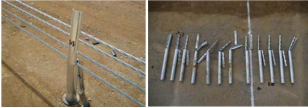
写真-14 衝突後の支柱の破損状況
