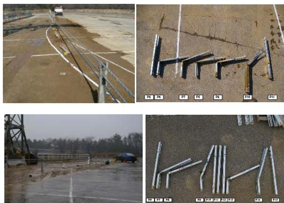
写真-9 衝突後の状況と損傷した支柱 (上段:大型車, 下段:乗用車)
