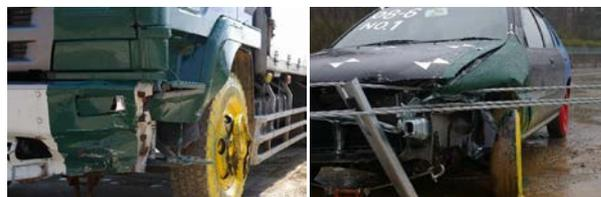
写真-10 衝突車両の破損状況 (左:大型車, 右:乗用車)
