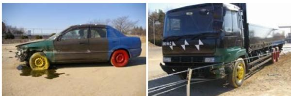
写真-18 衝突後の乗用車と大型車の破損状況
