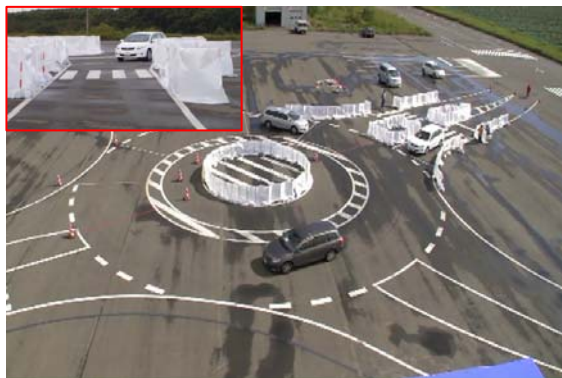
写真-1 走行試験の状況（堆雪高さ1.2m, 他走行車両有り）
