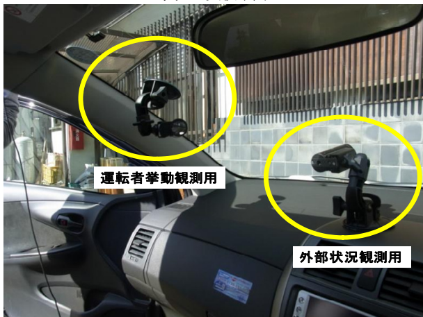
図-3 カメラ設置位置
