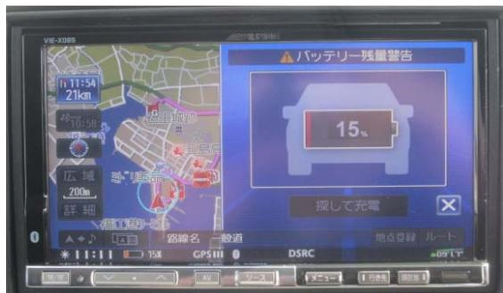
図4 充電残量の残り15%の警告例
