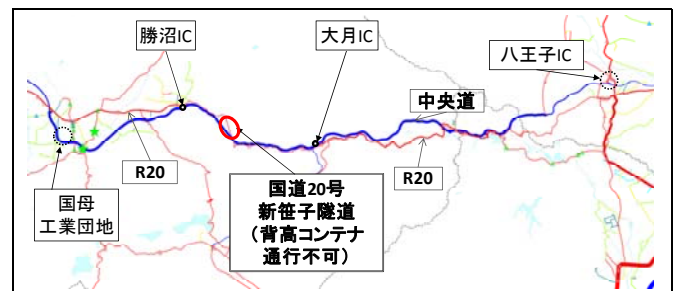
図-6 高さ制限による通行不可能箇所の例 (国道20号 新笹子隧道)
