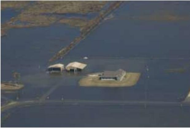
図-3 住宅の機能強化（土地の嵩上げ）により浸水を免れた例
