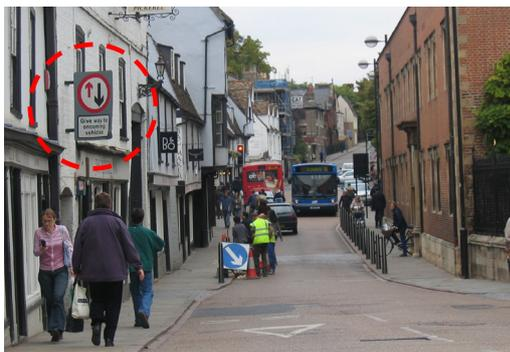
図-1 交通標識によるリンク部の通行優先権明示(英国)
