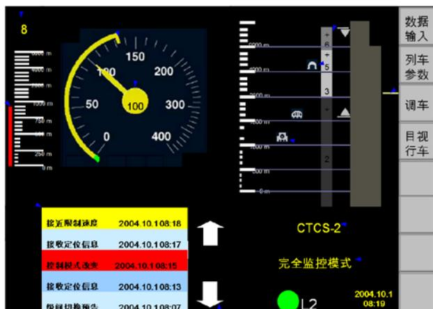
図-2 ATP 車内ディスプレイの一例
