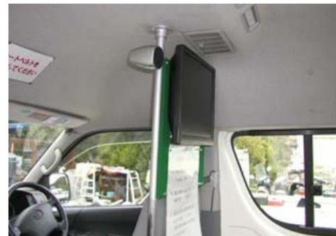
図-4 おと姫バスに設置された電子掲示板
