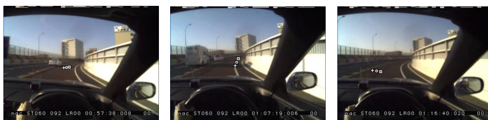
写真4.1 山王アイマーク注視点(左から通常走行，内側区間線注視走行，両側区間線注視走行)
