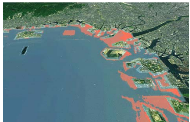
図-7 阪神港尼崎西宮芦屋区付近の水深10mの危険海域
