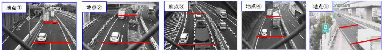
図-5 各画角と速度計測線
