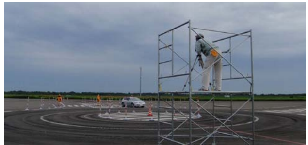
写真-4 撮影状況（除雪グレーダの運転者視線高さ）
