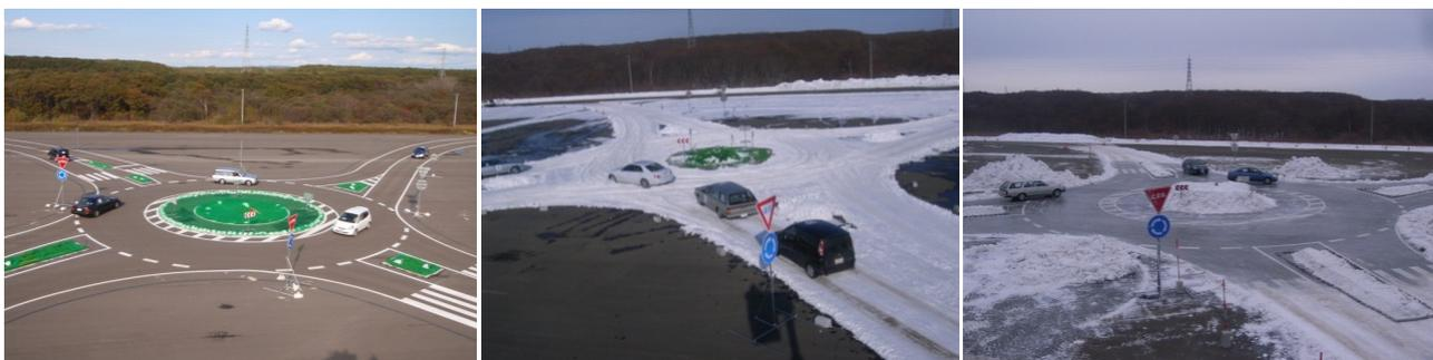
図-2 高所作業車から撮影した実験状況 (左: H22年度秋期乾燥路面、中: H21年度冬期圧雪路面、右: H22年度冬期氷板路面)
