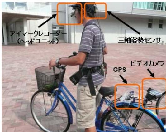
図-2 使用機材の装着状態
