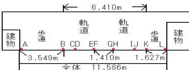
図-11 ファンタン・ラトゥール通り(グルノーブル, 仏)の断面図
