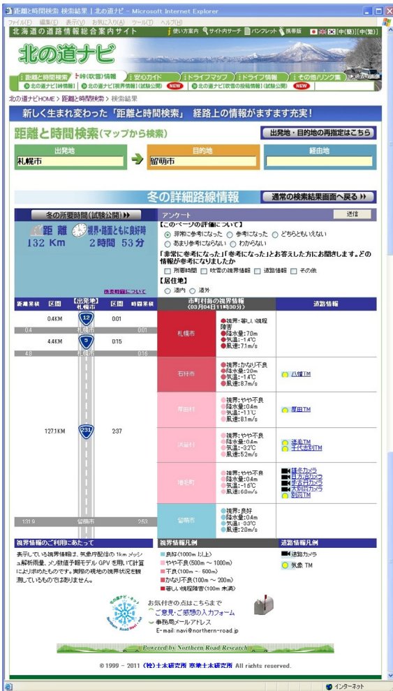
図11 「冬の詳細路線情報」の提供画面と情報コンテンツ(パソコン版) (吹雪の視界状況(右上)、道路の気象テレメータ(右下(左))、道路画像(右下(右))
