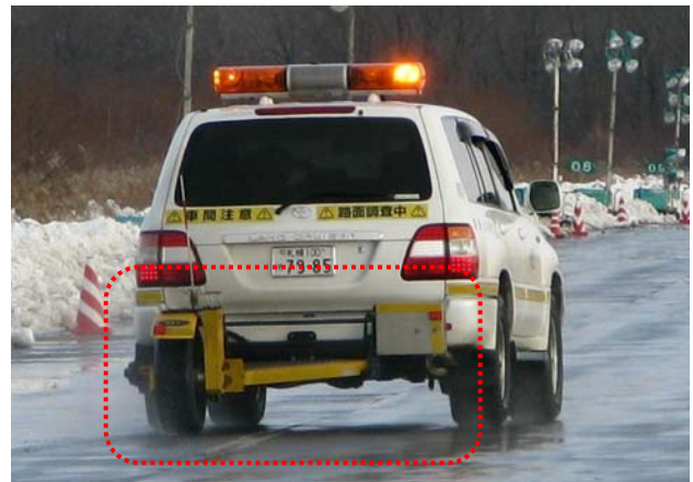
写真1 連続路面すべり抵抗値測定装置（CFT）
